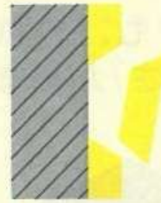
塗膜の剥がれ
