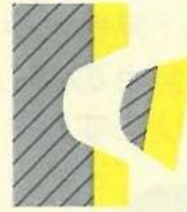
下地からの剥がれ
